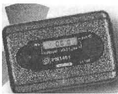
полиции, военных ведомств. Прибор прочен к падению с высоты 0,7 м на бетонный пол, устойчив к воздействию соляного тумана. Обнаруживает сверхмалые количества радиоактивных и ядерных материалов. Детектор: сцинтиллятор CsI(Tl). Время измерения: 0,25 с.
