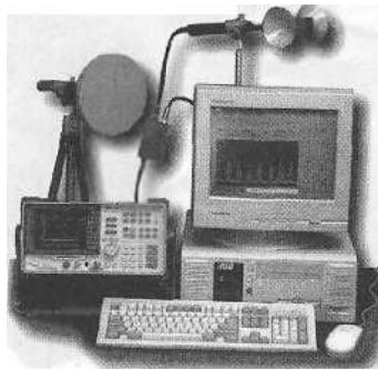
Представляет собой автоматизированный исследовательский программно-аппаратный комплекс нового поколения. Создан на базе современных анализаторов спектра Hewlett Packard, Rohde&Schwarz, Advantest, Tektronics, Anritsu, Marconi, управляемого ПЭВМ с использованием специального про-
